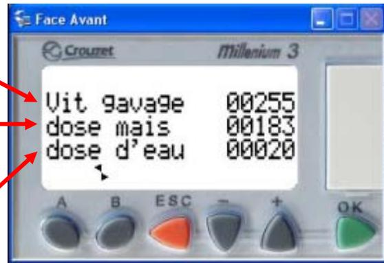
Pour paramétrer, utiliser les touches « + » et « - » pour changer de ligne. Lorsque la ligne est surlignée en noir et clignote, c'est que l'on est dessus. Si l'on presse « OK » la valeur se met à clignoter (sans sur lignage). Il est alors possible de la modifier. Pour valider, re-pressez le bouton « OK ».
