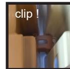
**Etape 4 :** à l'aide d'un tournevis plat large, fixer les 3 charnières (a) en exerçant un levier jusqu'à entendre 2 « clic »
