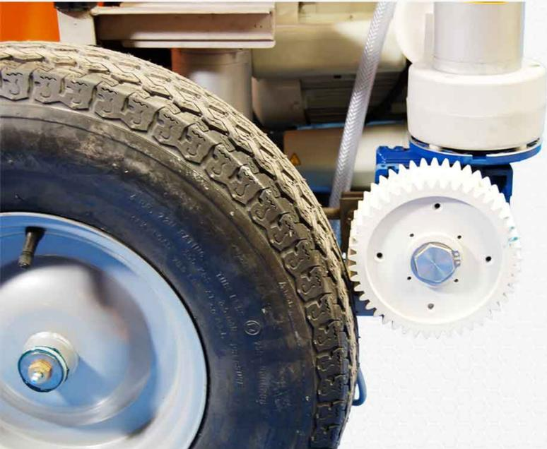
La gaveuse est équipée d'un système d'avancement en option. Celui-ci diffère suivant si vous gavez en parc ou en cage.
